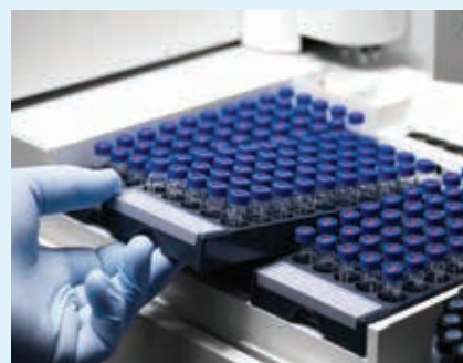
Лоток для флаконов для автоматической станции пробоподготовки для жидких проб Agilent 7693A
